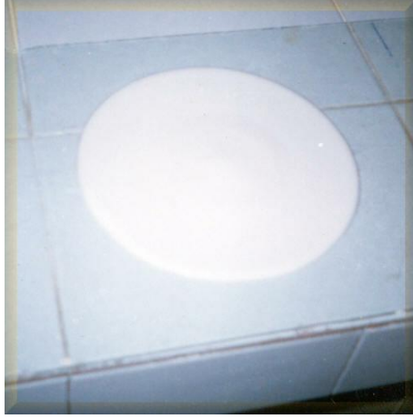
Resim 4. Alçı cam plaka üzerinde yayılarak dairesel şekil alır.
