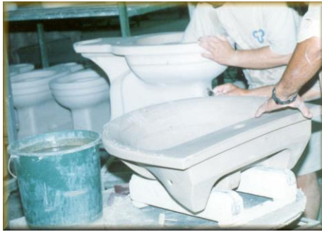
Resim 24. Ürüne bıçak rötuşunun yapılması
