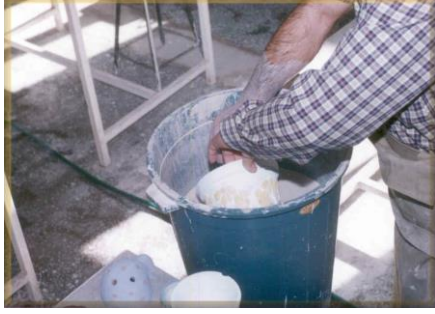
Resim 25, 26. Daldırma tekniği ile sırlama
