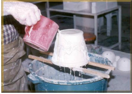
Resim 29. Akıtma tekniği ile sırlama
