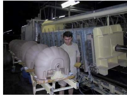
Resim 114. Yüksek basınç tezgahına döküm yapılması
