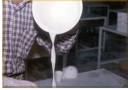
Resim 27, 28. Doldurma tekniği ile sırlama
