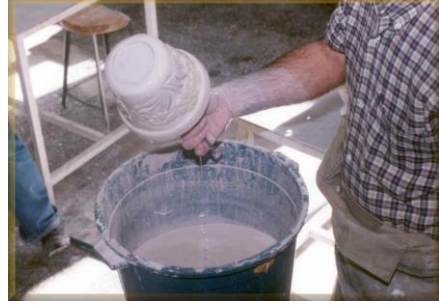
Resim 25, 26. Daldırma tekniği ile sırlama
