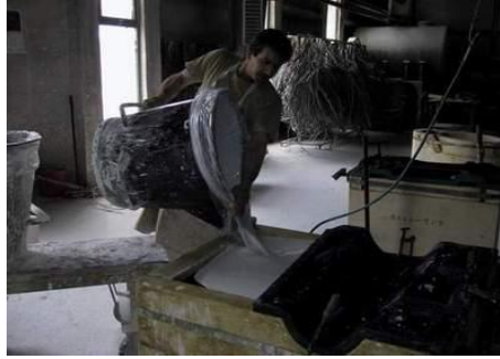
Resim 13. Hazırlanan alçının kalıba dökümü.
