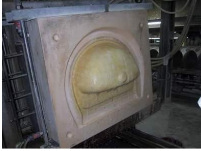
Resim 117. Yüksek basınç kalıbının otomatik yıkama işlemi
