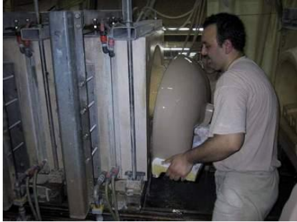
Resim 115. Yüksek basınç kalıbından ürünün mal alma ceketini ile alınışı
