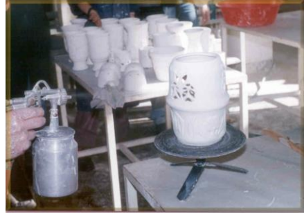
Resim 30. Püskürtme tekniği ile sırlama
