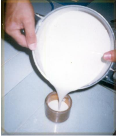
Resim 3. Alçının Schmit halkasına doldurulması.
