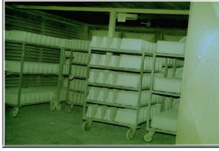
Resim 22. Ürünlerin kurutma kabininde kurutulması
