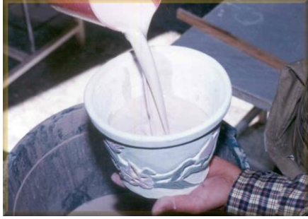
Resim 27, 28. Doldurma tekniği ile sırlama
