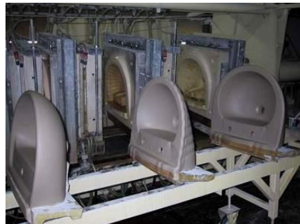
Resim 116. Ürünün mal alma ceketini ile reğalde kurumaya bırakılışı
